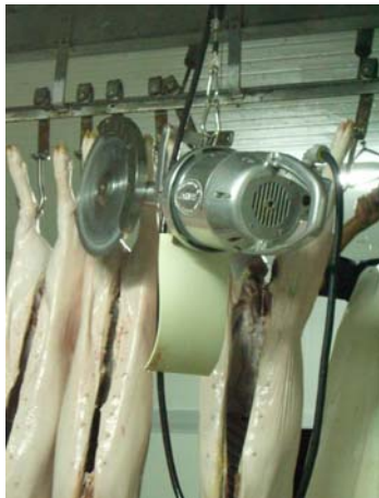
ภาพที่ 39 ผ่าซ้าด้วยเลื่อยไฟฟ้า
