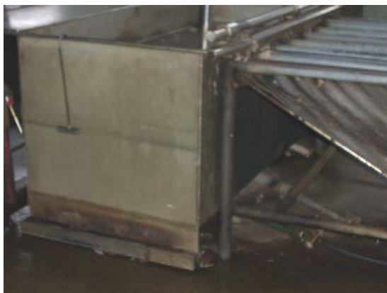
ภาพที่ 33 เครื่องลวกซากที่ผลิตในไทย (เตาตั้ง) โดย ใช้แก๊สเป็นเชื้อเพลิง
