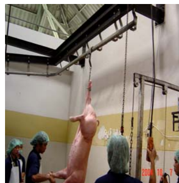
<- ระบบคานและราวแขวนช่วงแทงค่อไปยังอ่างลวกและป็นขนสุกรอัตโนมัติ ->
