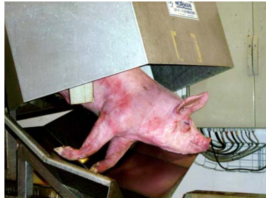
ภาพที่ 30 การทำให้สลบด้วยไฟฟ้าโดยผ่านเครื่องระบบอัตโนมัติ
