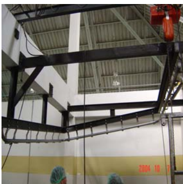
<- ระบบคานและราวแขวนช่วงแทงค่อไปยังอ่างลวกและป็นขนสุกรอัตโนมัติ ->
