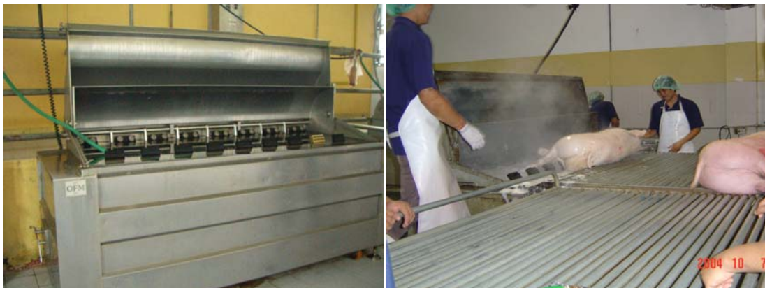
ภาพที่ 35 เครื่องลวกซากและชูดขน (Combined)
