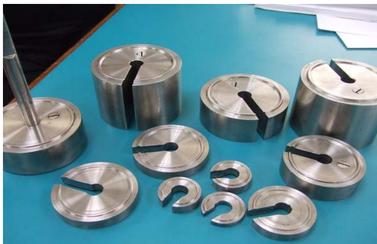
ภาพที่ 6 ภาพค้อนน้ำหนักแบบมาตรา เครื่องมืออนาตรวชชั่งตวงวัดในการทดสอบน้ำหนักเครื่องชั่ง
